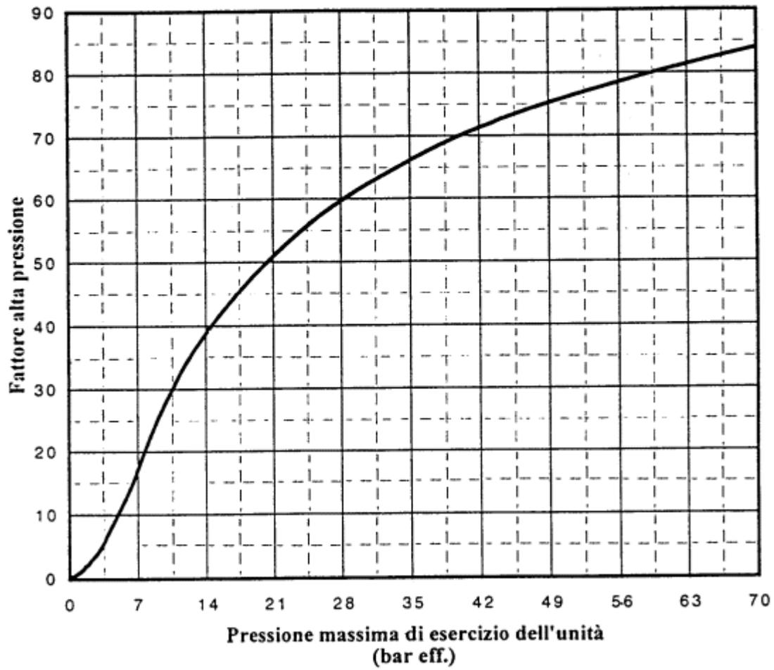
Figura II/5 Fattore di penalizzazione per i liquidi infiammabili in stoccaggio
